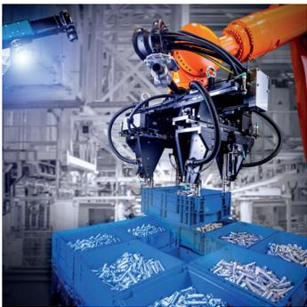
Das Haupteinsatzgebiet für das Depalettierungssystem VMT DeStack liegt in der Logistik und wird zur effizienten Entstapelung von Paletten eingesetzt.
