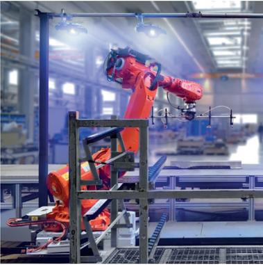
VMT FrameSense ist ein statisches, ausfallsicheres 3D-Messsystem, welches durch seine hochauflösenden 3D-Sensoren eine präzise Messung ermöglicht.
