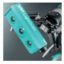
VMT OSC utiliza sensores de última generación para realizar la medición tridimensional de la posición y orientación de los objetos. Basándose en el principio de coincidencia estereoscópica, el objeto es capturado por dos sensores de imagen para calcular, por ejemplo, la posición tridimensional de cada punto de la imagen, independientemente de su color y es muy robusto ante influencias de luz externa.
