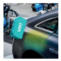
VMT OSC apuesta por un método de palpado óptico tridimensional basado en formas para determinar la posición de un objeto. En lugar de bordes, agujeros u otras características prominentes del objeto, se utiliza el contorno geométrico externo de una pieza o componente, total o parcialmente, para determinar su posición, orientación y ubicación.
