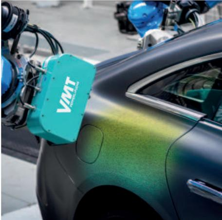
VMT OSC setzt bei der optischen dreidimensionalen Lagebestimmung auf ein formbasiertes Antastverfahren. Anstelle von Kanten, Löchern oder anderen prägnanten Objektmerkmalen wird die geometrische Außenkontur eines Bauteils oder Werkstücks ganz oder teilweise verwendet um dessen Position bzw. Lage und Orientierung zu ermitteln.
