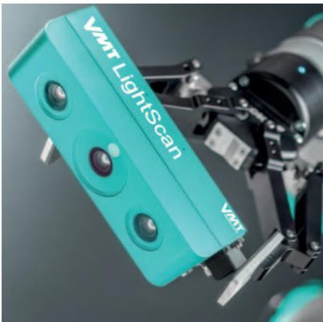
Für die formbasierte 3D-Messung der Position und der Orientierung von Objekten nutzt VMT OSC modernste 3D-Sensorik. Basierend auf dem Stereo-Matching Prinzip wird das Bauteil von zwei Bildsensoren erfasst um daraus beispielsweise die 3D-Position jedes einzelnen Bildpunktes zu berechnen, unabhängig von dessen Farbe und robust gegenüber Fremdlichteinflüssen.
