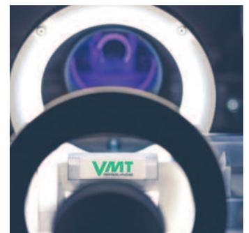
Mit VMT MultiCount ist eine sichere Bilanzierung beliebiger pharmazeutischer Behältnisse in einem weiten Spektrum möglich. Vials und Ampullen von 1 ml bis 100 ml und mit Durchmesser von 5 mm bis 50 mm werden sicher gezählt. Ebenso können unterschiedlichste Materialien, wie transparentes oder farbiges Glas, Kunststoffe oder farbige Kappen, automatisch geprüft werden.
