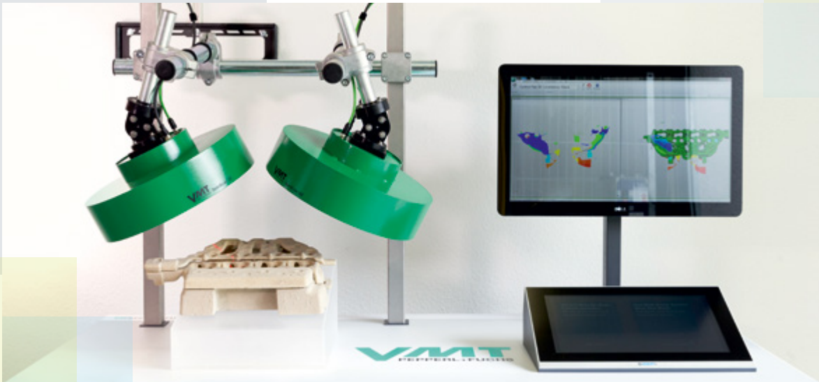
Bis ins kleinste Detail: Mit rotierenden Bewegungen erfassen vier perfekt aufeinander eingespielte SpinScan3D-Sensoren das exakte Abbild eines Sandkerns für den Motorblockguss.
